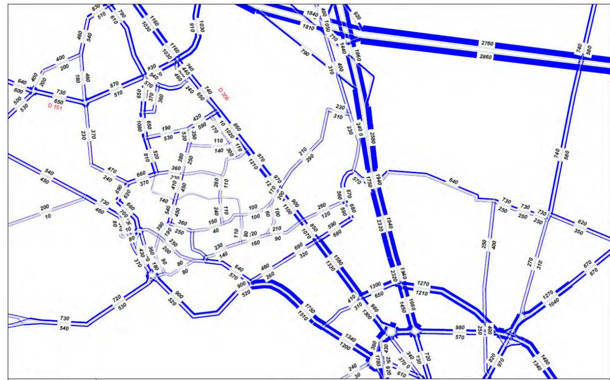
ZAC de Balory Traffic - Heure de pointe du soir Créé le : 23.10.2012 Horizon 2020 _ Scénario 3 : - ZAC Balory non réalisée/- RD306 requalifiée - Barreau de liaison entre la RD 636 et la RN 105 au nord de Melun réalisé/-Programme de 400 logements Cesson centre réalisé
